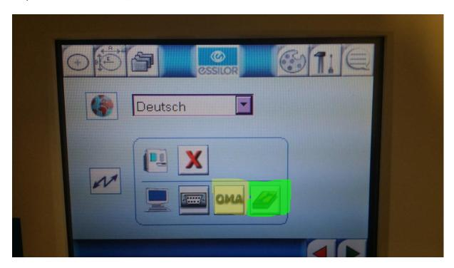
Durch drücken auf das Konfigurationssymbol (im Bild unten grün) können Sie die gewünschten Schnittstellenparameter einstellen, wir empfehlen hier "Speed: 19200", "Flow: Hardware".
